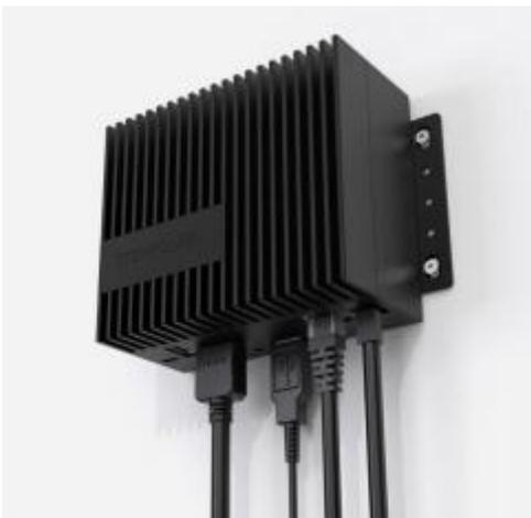
Stereolabs ZED Box是一款工业人工智能网关，为自主机器人和空间分析提供强大的边缘计算能力。它专门设计用于ZED 2和ZED 2i相机，由NVIDIA®Jetson™嵌入式GPU供电，能够部署最先进的人工智能和3D视觉解决方案。
